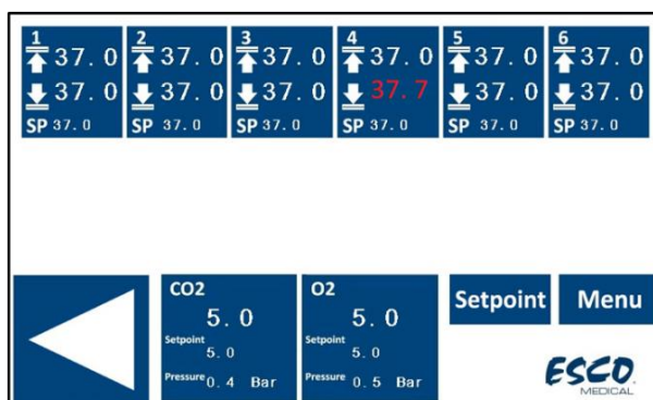
Figur 14.2 Visning af høj temperatur-alarmen på skærmen på MIRI® TL6 multiroom IVF-inkubatoren
