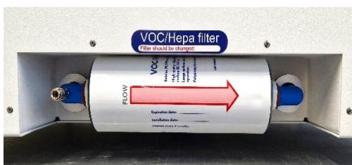
Figur 12.3 Korrekt monteret VOC/HEPA-filter
