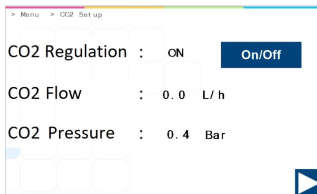
Figur 13.25 Undermenuen Opsætning af CO 2 -mængden på MIRI® TL6 og MIRI® TL12 multiroom IVF-inkubatoren
