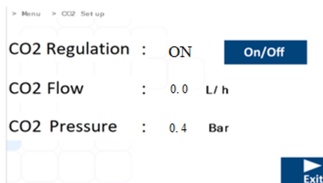
Figur 16.2 Undermenuen Opsætning af CO 2 i MIRI® TL6 og MIRI® TL12 multiroom IVF-inkubatoren
