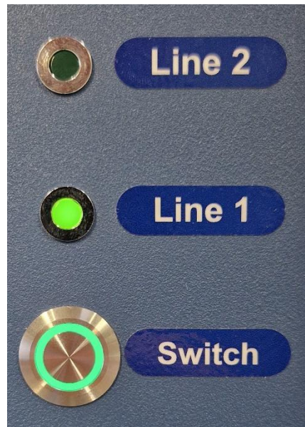
Figur 20.2 Linjeskift med linje 1 aktiv på MIRI® TL12 multiroom IVF-inkubatoren
