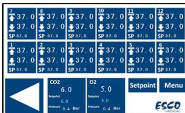
Figur 13.4 Hovedskærmen på MIRI® TL12 multiroom IVF-inkubatoren
