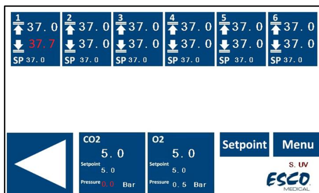
Figur 14.10 Visning af flere alarmer på skærmen på MIRI® TL6 multiroom IVF-inkubatoren
